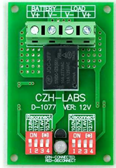
[2564]Módulo de desconexión de bajo voltaje LVD, 12 V 10 A, proteger duración de la batería
