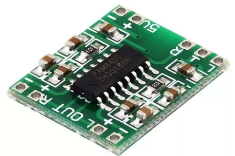
[1871]Modulo Amplificador De Audio Stereo Pam8403 Clase D 3w+3w
