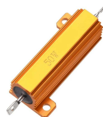
[5124]Resistencia 5% 50W 6R Metal Oro Rx24
