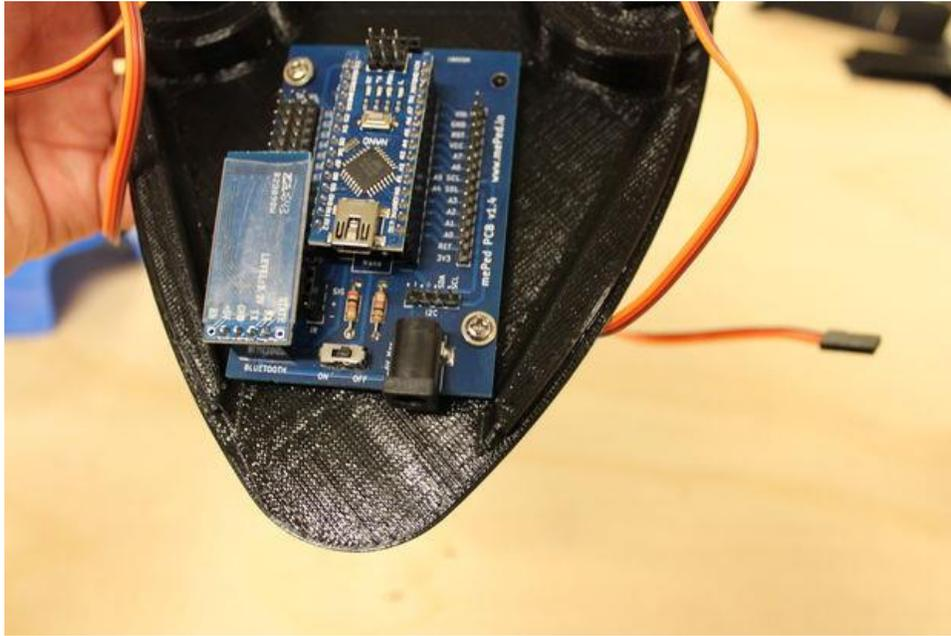
Use los Tornillos de Montaje de la Tarjeta para Unir la Tabla de Meted a la Base Critter.
